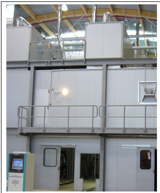
Anordnung der Technik in 3 Ebenen
