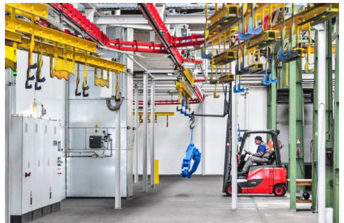
Abb. 9 Abnahme der Teile an der Hub- und Senkstation
