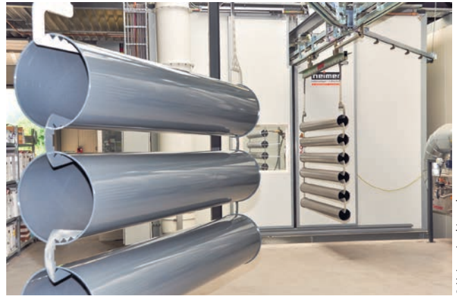
Teile in der Warteposition vor der manuellen Pulverkabine.
