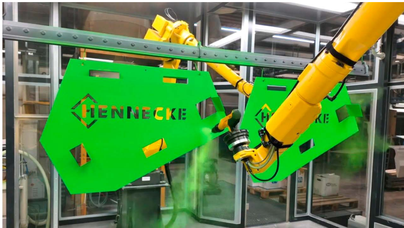
Zwei Lackierroboter übernehmen die Bewegungen des Mitarbeiters und sorgen ohne großen Programieraufwand für gleichbleibende Ergebnisse.
