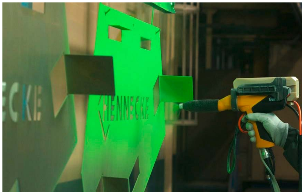
Mit dem neuen Teaching-System lackiert ein Mitarbeiter manuell, während das System seine Bewegungen erfasst.
